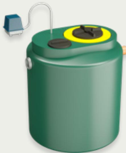
Gli **IMPIANTI A FANGHI ATTIVI** ad aerazione prolungata, compatti, detti anche ad ossidazione totale, sono sistemi a biomassa sospesa. I tempi di residenza idraulica assicurano la completa stabilizzazione dei fanghi. Nel reattore a fanghi attivi ad ossidazione totale, i fanghi prodotti vengono separati nel comparto di sedimentazione; i fanghi di supero generati dal processo possono quindi essere in fine smaltiti.
