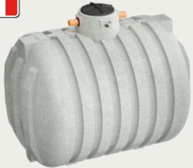
Tutti i manufatti della gamma sono realizzati in polietilene lineare rotostampato. L'intera gamma riguarda esclusivamente sistemi in contenitori particolarmente studiati per la funzione che potranno essere attrezzati secondo le necessità dell'utilizzatore e del conduttore. Si tratta di manufatti cavi destinati a contenere acque meteoriche perchè risultino disponibili all'azione di una elettropompa sommersibile
